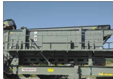
Гидравлический привод опускает грохот в «походное» положение
