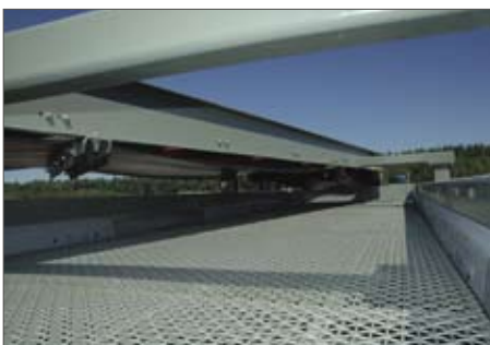
Лента питающего конвейера грохота м. б. смещена в сторону, освобождая доступ при смене сита
