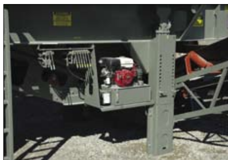
Гидравлические приводы приводят завод в рабочее положение за считанные минуты
