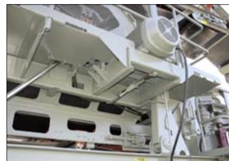
Мотор грохота выдвигается и задвигается при помощи храпового механизма. При этом открывается легкий доступ к хвосту конвейера
