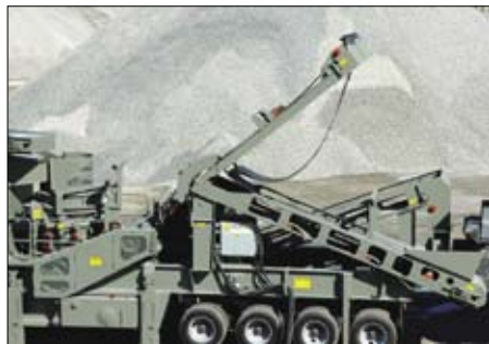
Складывающийся конвейер открывает беспрепятственный доступ к конусной дробилке для обслуживания
